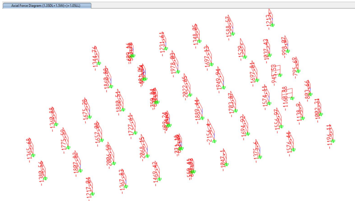
Esfuerzo Axil [kN]. Cargas de urbanización. Combinación 1.35G + 1.5W + 1.05Q
